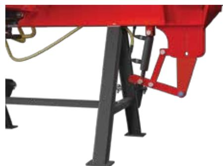
732 Befestigung des Messers an der WS 90
