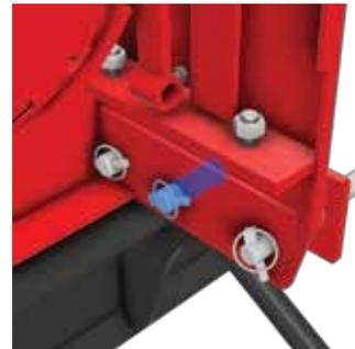
6.4 Bolzen zum Lösen der Schaufel
