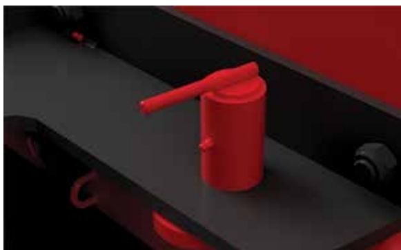
6.3.1 Bolzen zum Arretieren der Schwenkbewegung
