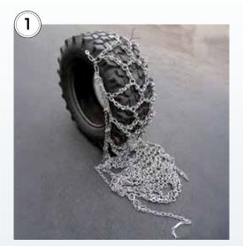
Legg kjettingen på bakken bak dekket med piggene opp og stiftekoblingene på banen nærmest dekket. Fest en snor i dekkmønsteret og gjennom stiftekoblingene på både side- og banekjetting. Kjør fremover til hele kjettingen er på plass.
