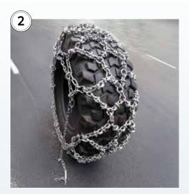
Koble bane/piggkjettingen først. Deretter sidekjettingene. Bruk av strammetang vil forenkle montering og justering. Pass på at mønsteret blir korrekt i skjøten. Husk å slå inn spennstiften i stifekoblingene.
