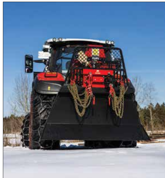
Sort port viser pullmatic som gjør jobben med å dra ut vaieren ut til en lek
