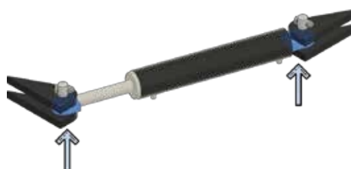
10.3.2 Vérins de pivotement du bogie Les deux côtés de la remorque
