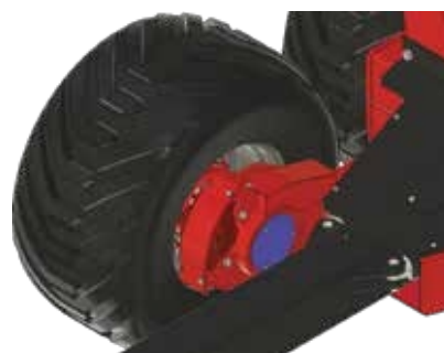
10.1.1 Couvercle d'accès aux boulons du moteur du moyeu
