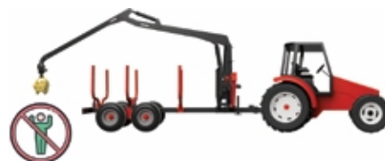
2.2.1 Ne jamais marcher ou rester sous la grue ou la charge pendant son utilisation
