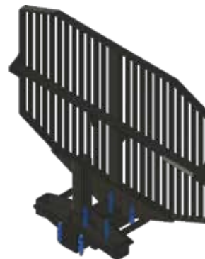
5.6.1 Boulons pour la fixation de la grille
