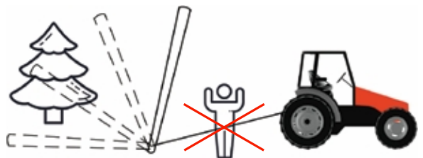
1.5.4 Les obstacles peuvent faire basculer le bois vers le haut ou sur le côté.
