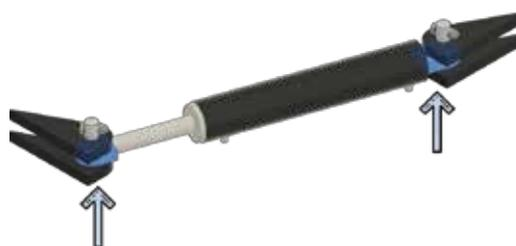
10.3.2 Schwenkzylinder zum Drehgestell Beide Seiten des Anhängers
