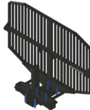
5.6.1 Bolzen zur Befestigung des Gitters
