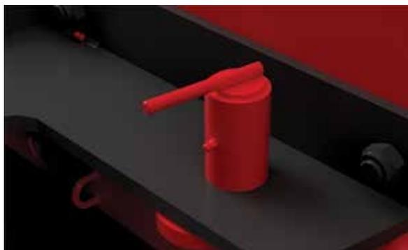
6.3.1 Bolzen zum Verriegeln der Drehung
