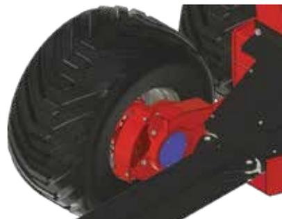
10.1.1 Abdeckung für den Zugang zu den Bolzen des Nabenmotors
