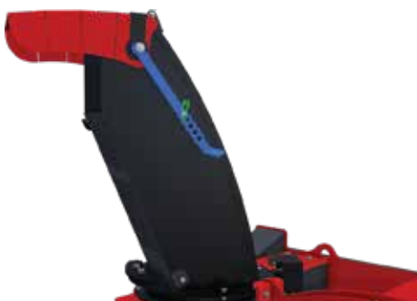
6.4.1 Mekanisk nedbrekk av tut
