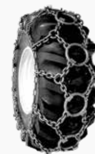
RINGKJETTING Ringkjetting med godt grep for skiddere eller traktorer i skogen SIDE 13
