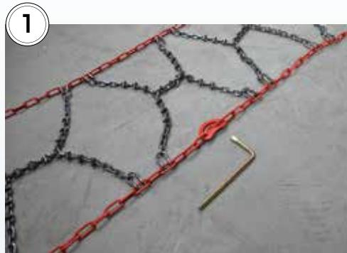
Legg kjettingen flatt på bakken og kontroller at den ikke er vridd. Sørg for at sidestrammerne er åpne. Sidestrammerne skal være på utsiden av dekket.
