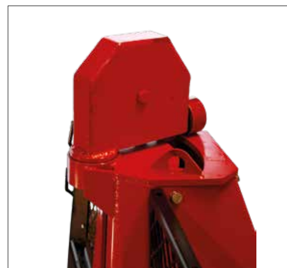
Toppblokk med spolapparat
