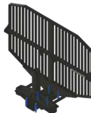
5.5.1 Bolter for innfestning av gitter
