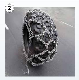
Koble bane/piggkjettingen først. Deretter sidekjettingene. Bruk av strammetang vil forenkle montering og justering. Pass på at mønsteret blir korrekt i skjøten. Husk å slå inn spennstiften i stifekoblingene.
