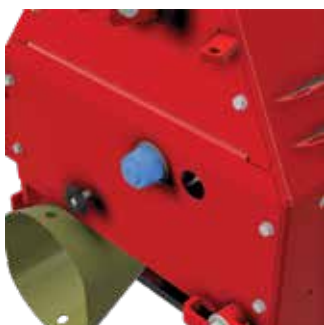
7.3.1 Mutter for justering av kløtsj
