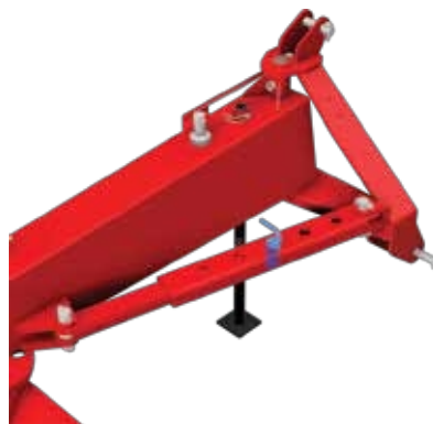
6.2.2 Mechanische Einstellung des Auslegers
