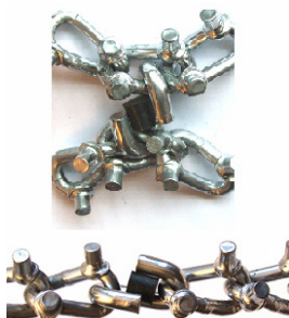
Reparasjon med S- krok øverst. Reparasjon med Z krok under.
