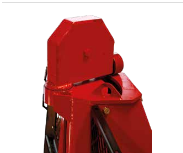
Toppblokk med spolapparat
