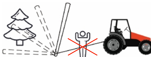
2.5.4 Hindernisse können dazu führen, dass das Holz nach oben oder zur Seite kippt
