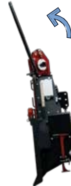
5.2.3 Neigen Sie die Winde vom Traktor weg.
