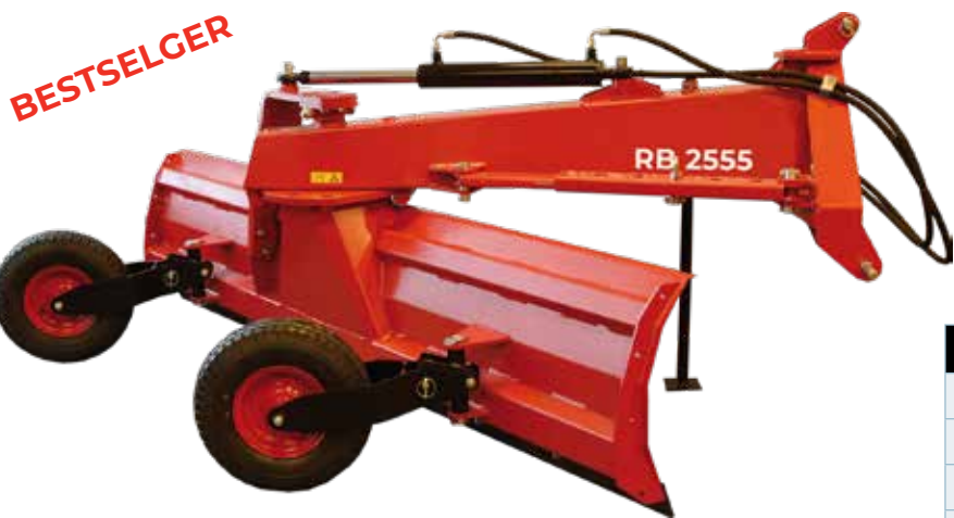
Bildet viser RB 2555 med hjul, hydraulisk regulering av skjær og trepunkt feste (ekstra utstyr)
