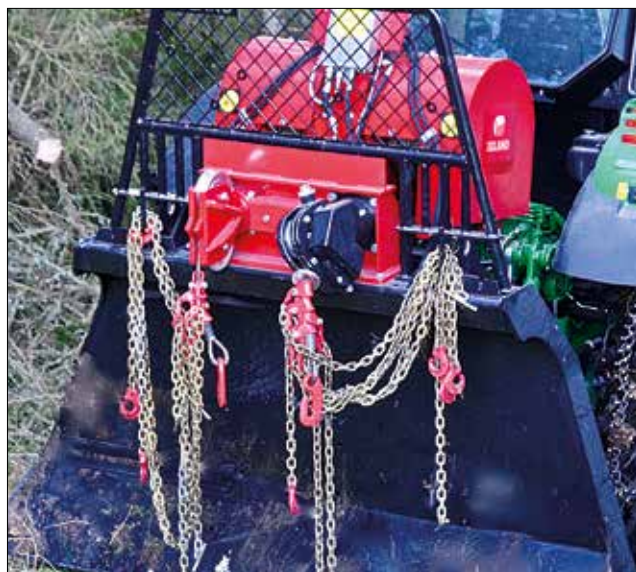
Sort port viser pullmatic som gjør jobben med å dra ut vaieren ut til en lek
