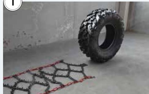
Legg kjettingen bak/foran dekket med piggene opp og låsene mot dekket.
