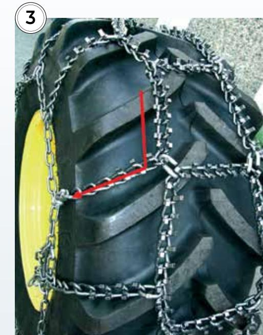
3. Når kjettingen er ferdig montert etterjusteres evt. lengde og stramming på sidekjettingen og plasseringen av sidestroppene som er festet med sjakler. Ferdig justert skal sidestroppene peke mest mulig rett inn mot dekkets sentrum. Evt. overflødig kjetting festes eller kappes vekk.
