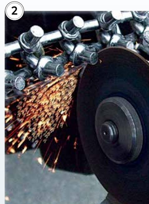
2. TRAKTOR har en demonterbar seksjon i enden. Denne fjernes ved behov. Visse tilfeller kan det være nødvendig å kappe vekk ytterligere kjetting ved montering (markert med rødt på bilde 1).
