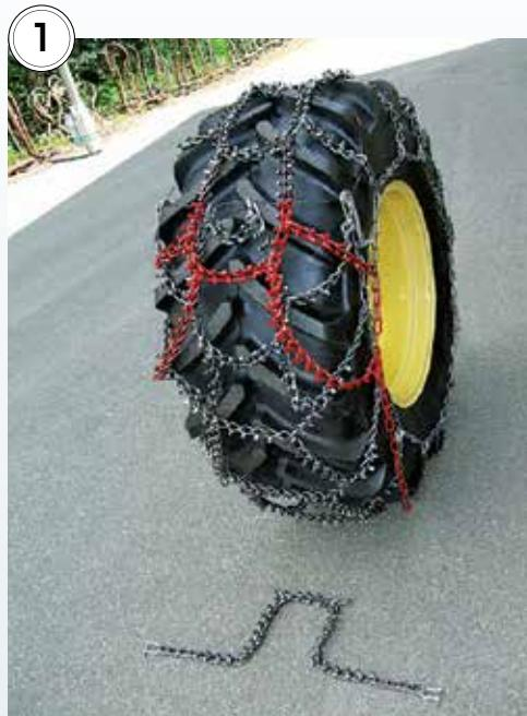
1. Legg kjettingen bak dekket med piggene opp og låsene mot dekket. Heng kjettingen fast i dekkets mønster. Kjør fremover og la kjettingen legge seg på.
