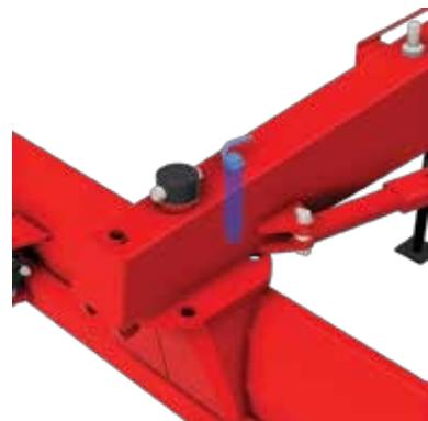
5.15 Boulon de verrouillage pour lame de coupe
