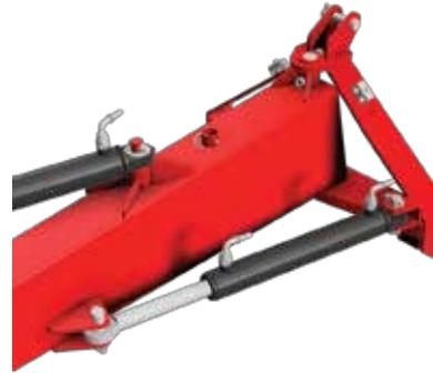
5.14 Cylindre pour le réglage hydraulique de la flèche
